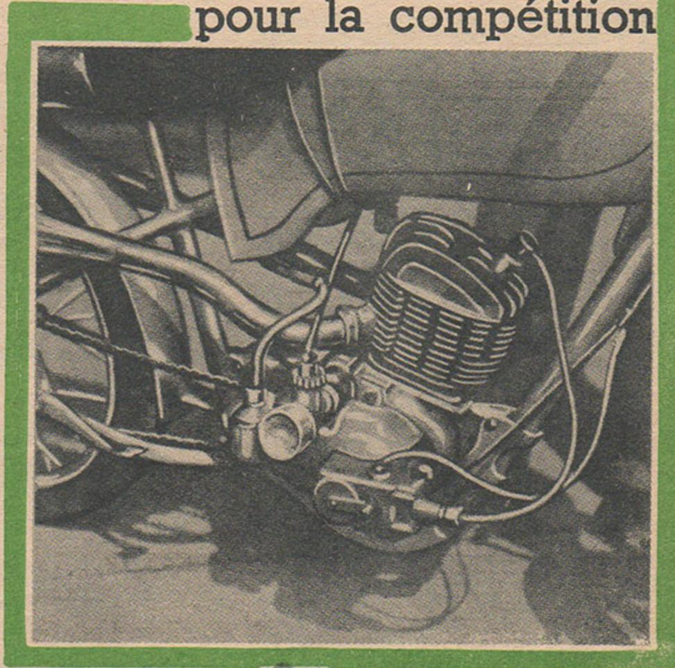
La 125 deux temps de Doring, est actuellement une des plus redoutables machines de sa catégorie en Allemagne. Alimentation par distributeur rotatif, et allumage par magnéto.
