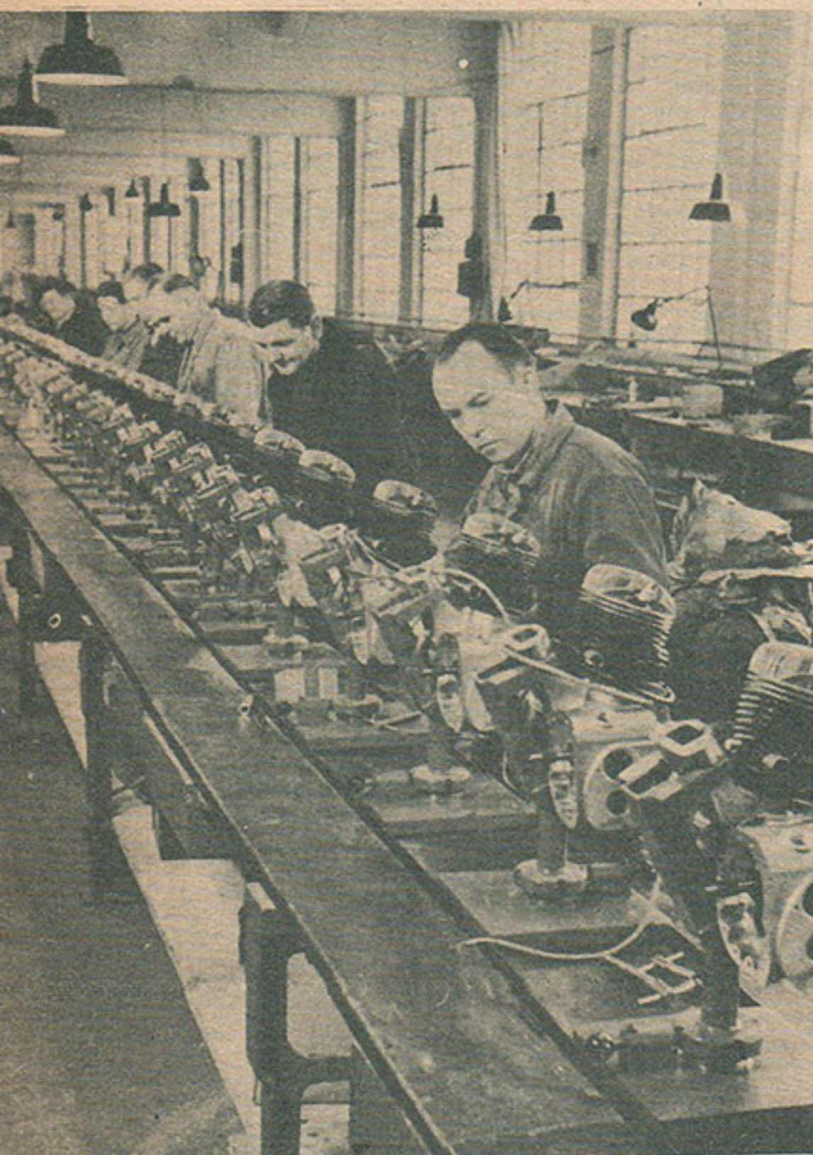
Aux usines N.S.U. la chaîne de montage des moteurs Lambretta, construits sous licence.
