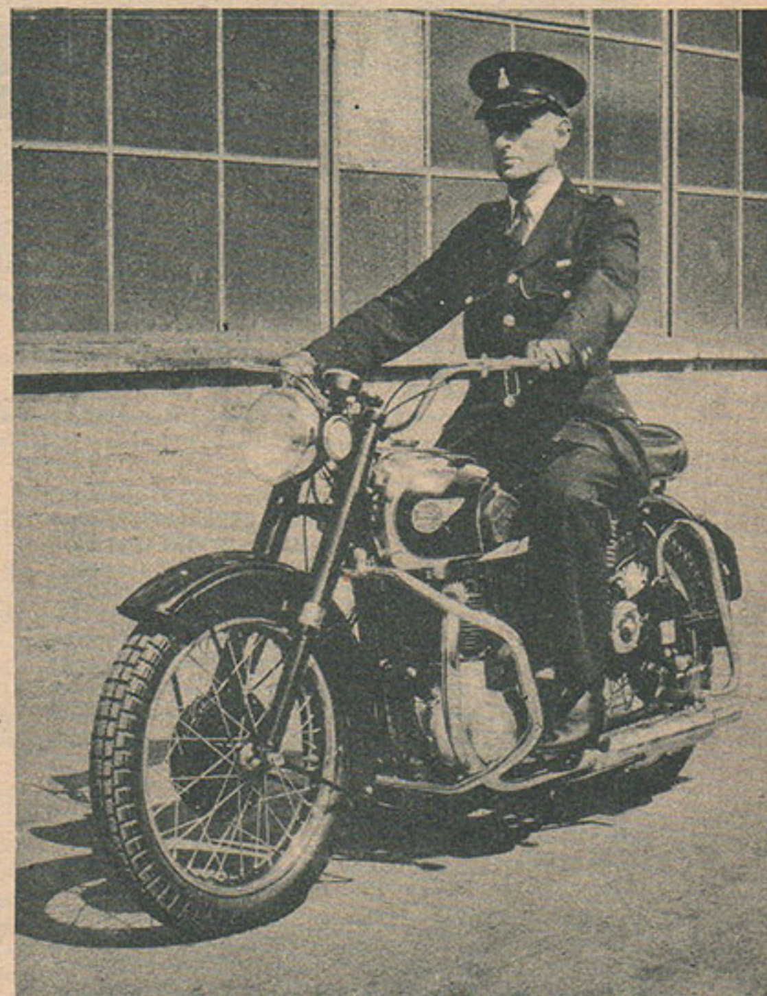
La nouvelle B.S.A. 650 modèle Police se distingue des Golden Flash par ses pare-chocs, son guidon type américain, etc...
