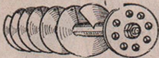
L'une des conceptions les plus modernes du silencieux est le cloisonnement en spirales, spires égales ou mieux, inégales et au besoin la queue de poisson esthétique et pratique.
