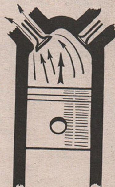
4<sup>e</sup> temps (échappement) - Les gaz brûlés sont chassés par la remontée du piston vers l'échappement, dont la soupape est ouverte.
