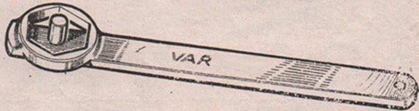
Ci-dessus, et à droite, une clé spéciale centrée pour le blocage de l'écrou inférieur de la douille de direction Mobylette.
