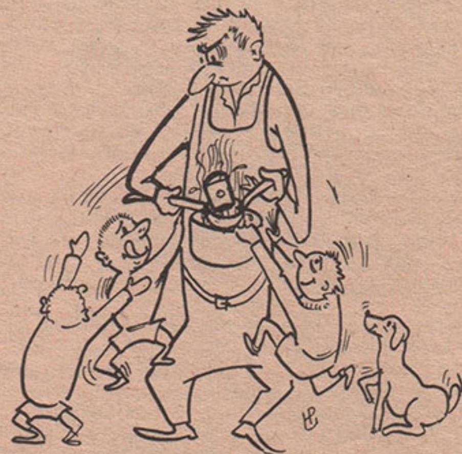
En chauffant le piston, l'axe prendra plus facilement place dans son logement.
