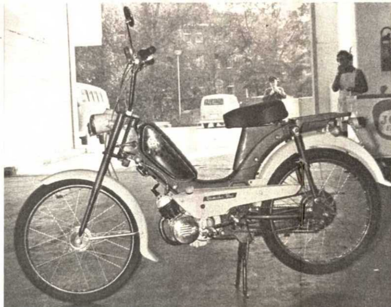
En première mondiale, Yamaha avait amené à Cologne, en toute dernière minute, un 50 cc utilitaire (ci-dessus) à distributeur rotatif, entièrement automatique et présenté en deux versions : réservoir à l'avant ou à l'arrière. On n'a pas l'habitude de voir, dans les Salons, de marques polonaises. Et pourtant, à Cologne, l'industrie de ce pays était représentée par Komar dont vous pouvez voir ci-dessous un modèle de cyclomoteurs très classique (0,8, 1 ou 1,4 CV pour le moteur).
