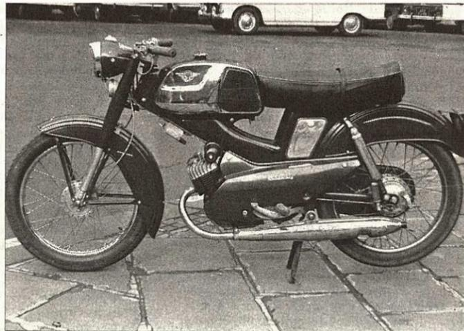
**Freinage** : Freins AV et AR à tambour (Ø 100 et 115 mm), délicats à régler, mais puissants et progressifs. Tendance au fading pour le frein AV.
