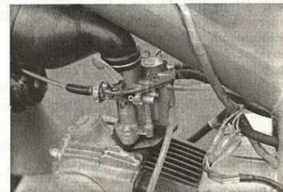
Le carburateur Keihin de 13 mm comporte un petit levier fermant le volet d'air.
