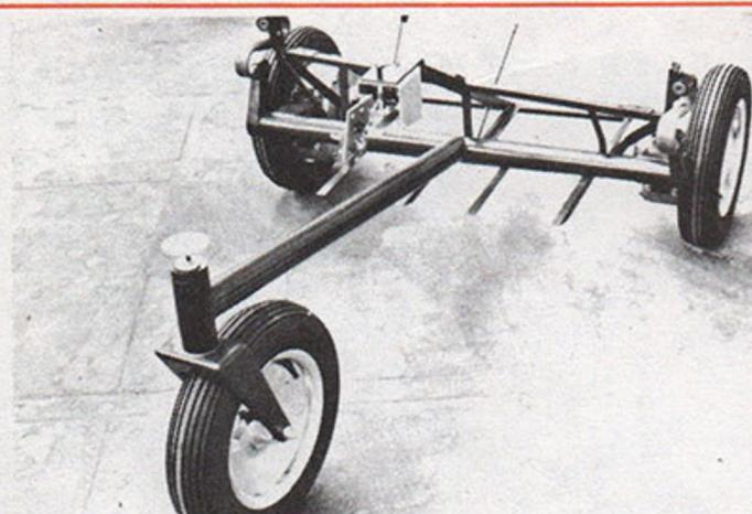
Le châssis tubulaire en T comporte 2 éléments. Le premier, non suspendu, supporte le second qui reçoit la coque et toute la partie électronique.
