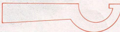
Type de clef le plus fréquemment utilisé pour le démontage des écrous d'échappement.
