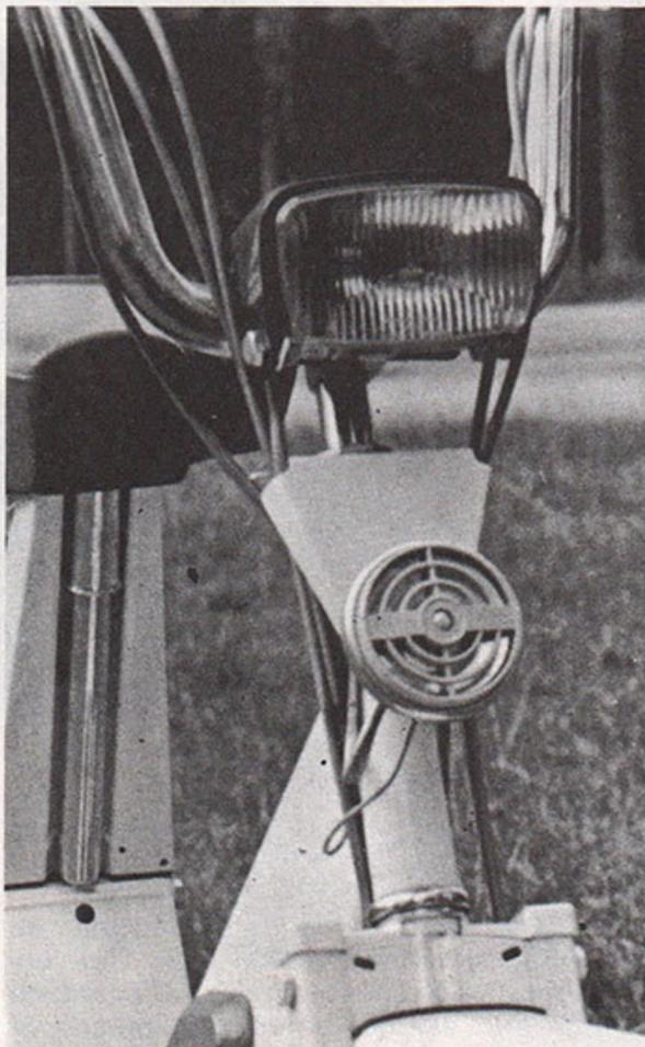
*Un équipement électrique moderne et complet : projecteur au faisceau orientable et avertisseur sonore réglable en tonalité.*
