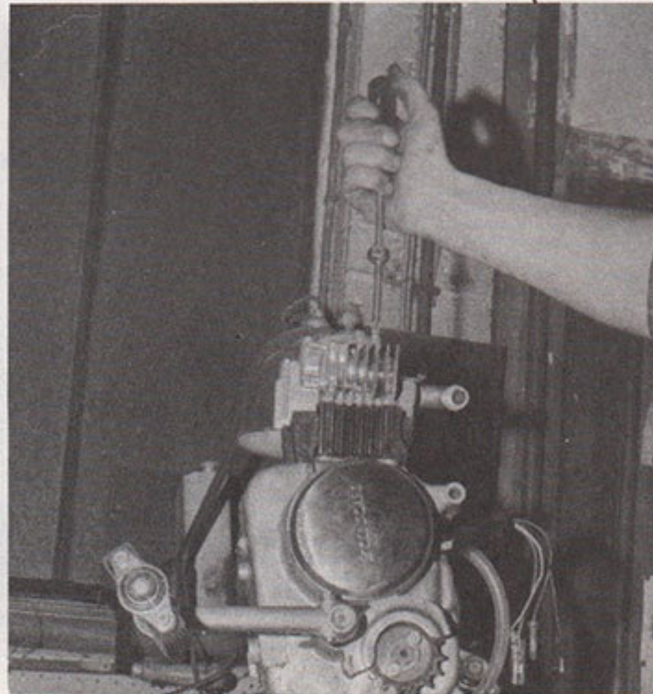
Dévisage du couvercle porte-basculer. Remarquez que sur le tournevis cruciforme de M. Poitevin est soudé un écrou ; avec une clef plate ou à œil on peut imprimer le mouvement de rotation au tournevis en réservant toute sa force pour peser sur le manche.
