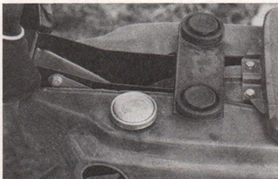
La selle articulée à l'avant — dont on pourra regretter qu'elle ne soit pas verrouillée — découvre en basculant le coffre à outils — c'est un grand mot — et le bouchon de remplissage du réservoir d'essence.
