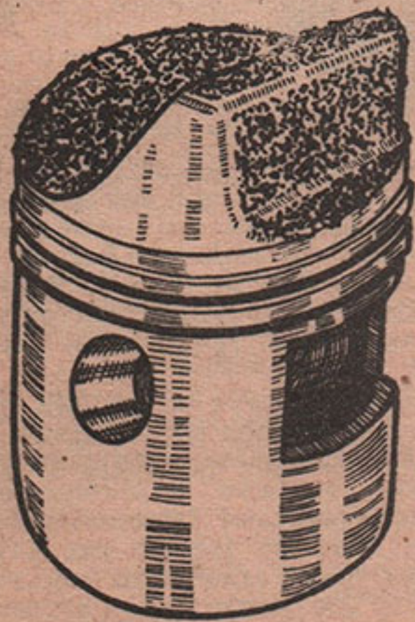
Sur les deux-temps, le calaminage est sensiblement plus rapide.
