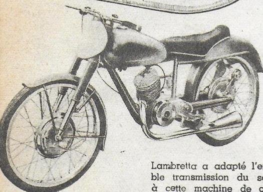
Lambretta a adapté l'ensemble transmission du scooter à cette machine de circuit.
