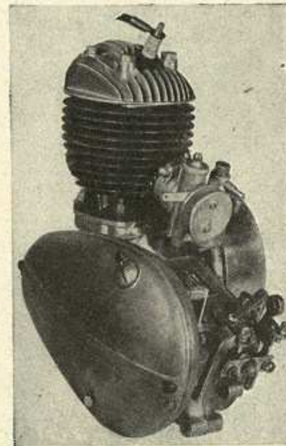
Ci-contre : Le moteur 98 cc Villiers qui équipe la V.M.L. Automoto, la S 2 S Monet-Goyon et la Starlett. On remarque la commande du changement de vitesses située à la partie postérieure du carter.
