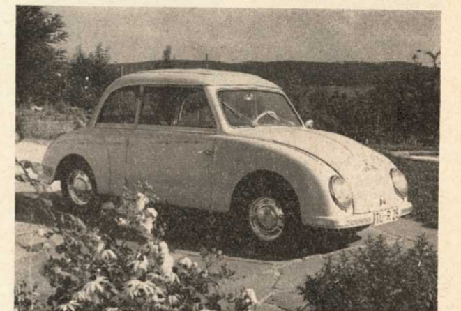
La MAICO 500, 4 places, moteur bicylindre 2 temps, châssis à poutre centrale
