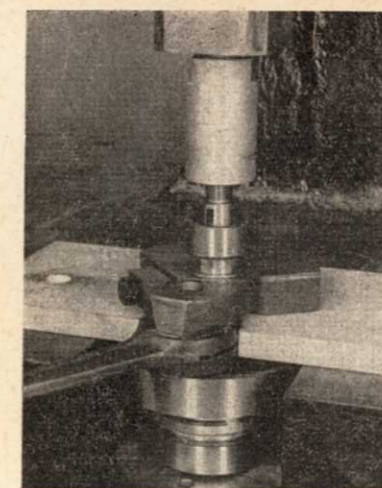
Fig. 18. — Mise en place, à la presse, des chemins de roulements du vilebrequin avec nez de presse 1.109 et plaque d'appui
