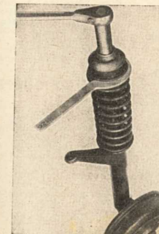
Fig. 96. — Déblocage de l'écrou supérieur en tenant le tampon avec la clé 1.126
