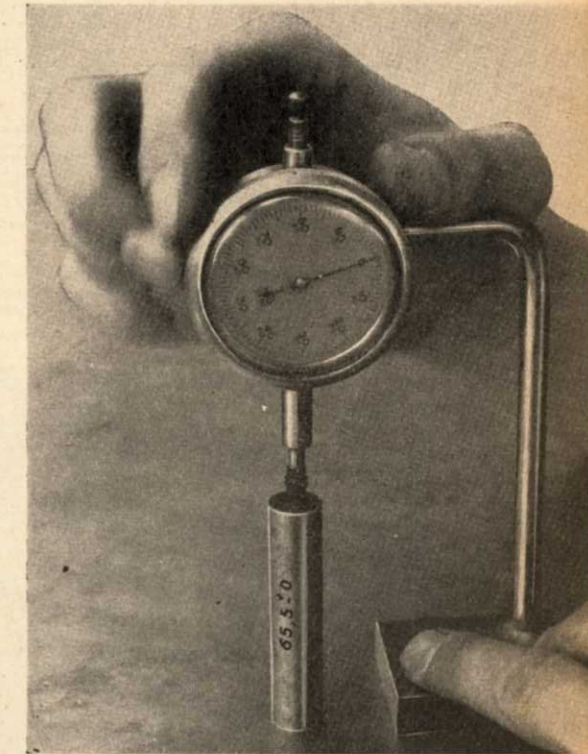
Fig. 66 C. — Mise à zéro du comparateur sur la cale 4 (65,5 ± 0 B). Comparateur et support 3
