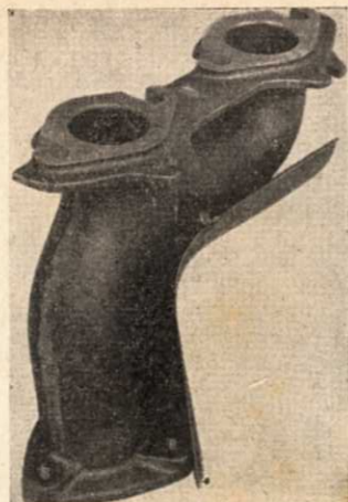
Fig. 11. — Collecteur d'échappement déposé
