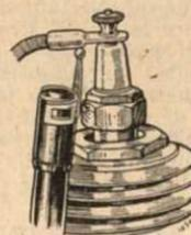
réservoir dont le corps en ébonite, évitera toute commotion. Il suffit de retourner l'agrafe de fixation, la boucle de celle-ci sera appliquée contre l'électrode central et l'étincelle devra jaillir entre la bague et le culot de la bougie.
