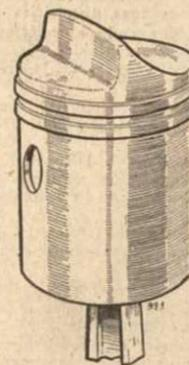
Pour éviter le cliquetis, on peut disposer l'axe perpendiculairement à l'arête du déflecteur, ce qui répartit également les masses...
