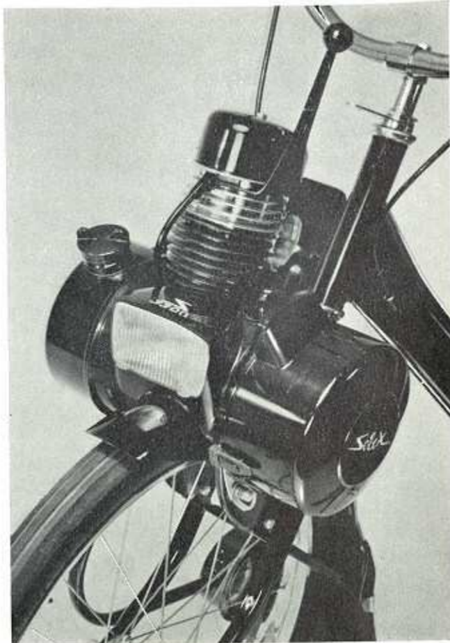
Le bloc-moteur du nouveau VELOSOLEX « S. 3.300 » avec son phare rectangulaire réglable, à grand éclairage.
