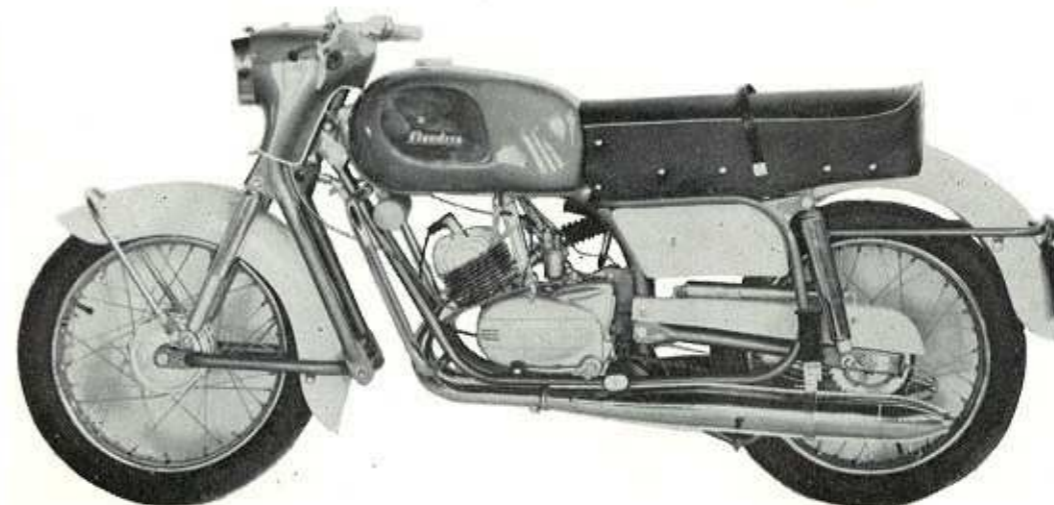
Exemple de la tendance actuelle, le vélomoteur léger de 50 cmc type « CONCORDE », présenté par FLANDRIA, est doté d'un bloc moteur à 5 vitesses commandées par sélecteur au pied; la puissance est de 5 CV et le freinage a été amélioré, ici par des freins à disque.
