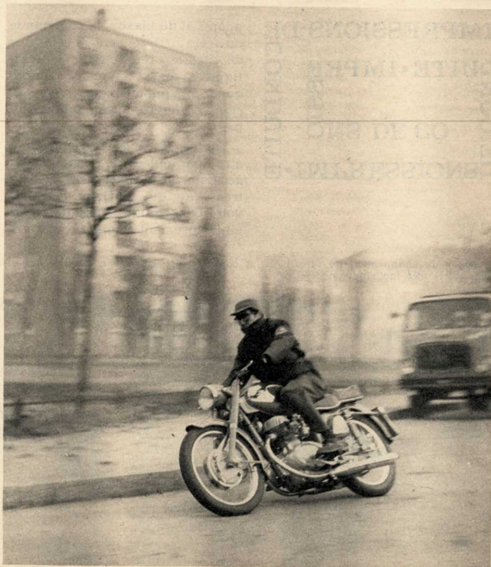
Sur les flancs de la moto, il y a deux cassettes en tôle emboutie qui contiennent, l'une tous les outils de bord (largement suffisants pour les réparations de fortune), l'autre est vide mais peut servir à des pièces de rechange, chiffons, etc...
