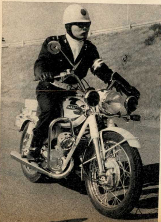
Les motos des policiers japonais, ici une Yamaha 350 bicylindre, sont abondamment équipées d'accessoires divers: sirène très puissante, tachymètre de précision, mouchard pour éviter toute contestation, phares rouges, signaux de direction, grands rétroviseurs, pharmacies de secours, etc.
