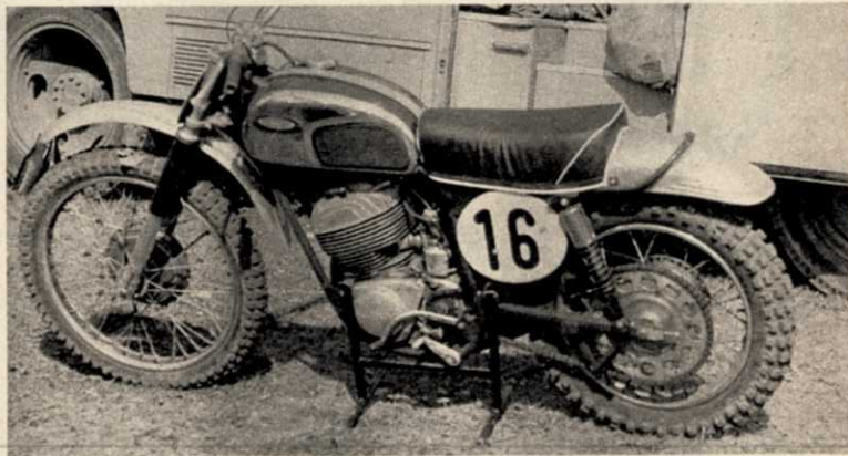
La Jawa 400 de cross, d'abord avec cadre « à banane » et actuellement plus classique, cadre « double berceau » tubulaire.
