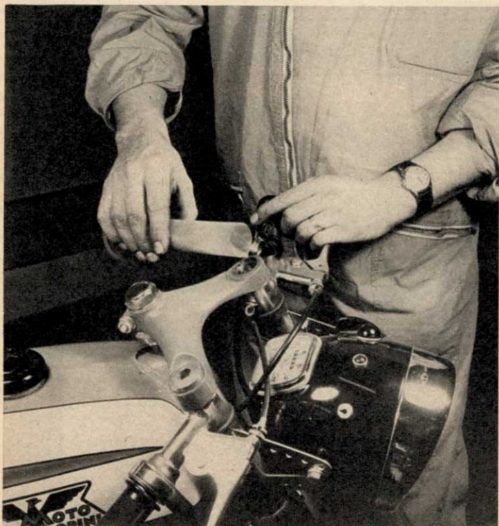
Rétablissement du niveau d'huile dans les tiges de la fourche.
