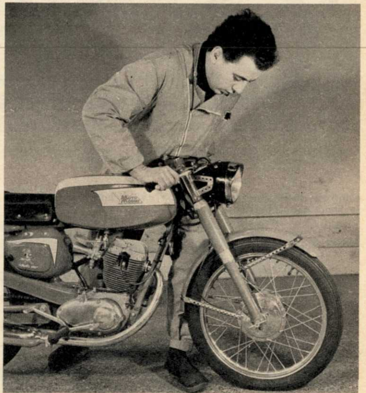
Contrôle de jeux éventuels dans les tiges de la fourche et le conduit de direction.
