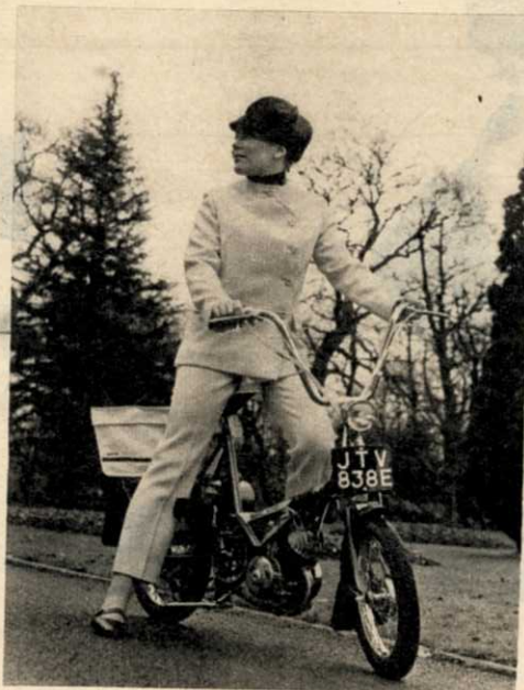
Deux mini-utilitaires récemment présentés en Angleterre: à gauche, le « Wisp » Raleigh, à droite, le « Scamp » Clark. Leurs embrayages automatiques, leurs cadres ouverts et leurs petites roues seront plus particulièrement appréciés des utilisatrices.
