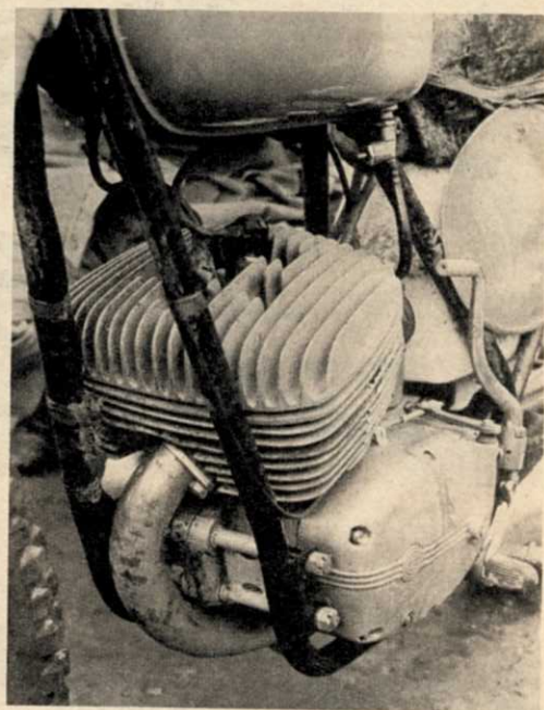
La C.Z. « officielle » 250 à double allumage; à droite détail du moteur C.Z. d'usine pour compétitions des 500 cc. (il est aussi construit en deux autres versions: 380 et 400 cc.).
