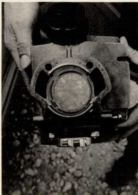
Le même vue de dessous. Les entrées des transferts principaux sont d'une taille impressionnante. Contrairement à la R3 de tourisme, les transferts additionnels ne sont pas de simples rainures. En bas la bride élastique sur laquelle est monté le carburateur.
