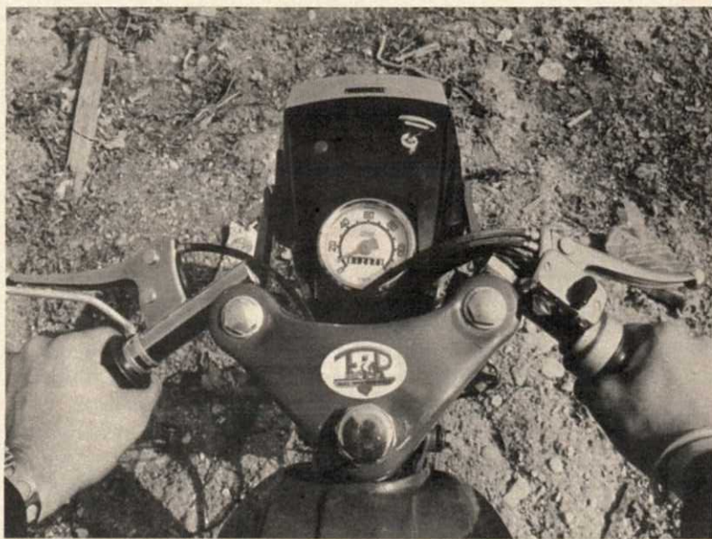
Mis à part l'inqualifiable clef de contact et la fixation de rétroviseur, l'équipement de ce vélomoteur est très complet. Noter, du côté droit, les deux câbles de commande du double frein avant
