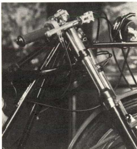
Les tubes bien entrecroisés près de la colonne de direction sont le gage d'une bonne rigidité.
