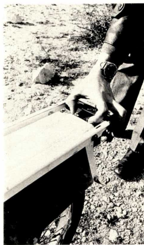
Le feu arrière est simplement maintenu par un ressort en U qu'il suffit de comprimer pour libérer le cabochon. Outre le fait qu'il est à la portée de tout le monde, la tension du ressort n'est pas assez forte pour l'empêcher de tomber lors de chocs ou vibrations.
