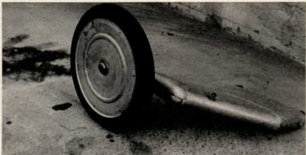
L'ancien side de Cavanna. Profil en aile de Stuka. Poids 65 Kg. Suspension par anneau de caoutchouc Neiman et amortisseur à friction des vieilles Guzzi. Pendant les tentatives, le flasque recouvrant la roue sera enlevé car il provoquait des vibrations.
