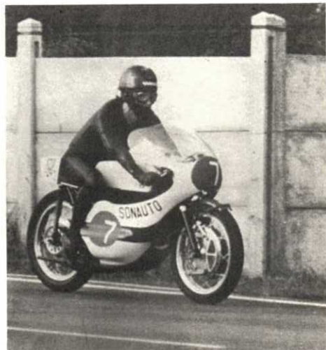
Au freinage, la suspension avant s'enfonce presque complètement alors que les amortisseurs arrière sont totalement détendus.
