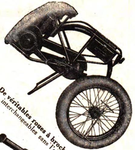
**De véritables roues à broches, démontables et interchangeables sans l'aide d'aucun outil.**
