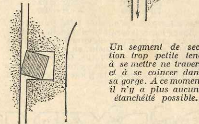
Un segment doit coulisser librement dans sa gorge, mais on ne doit tolérer aucun jeu latéral.
