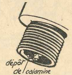
Une bougie dont les électrodes sont calaminées, donne aussi des déboires. Encore un point à surveiller.
