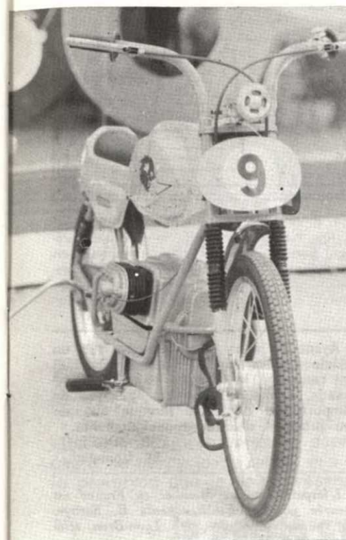
Remarquez l'avertisseur, les poignées de freins, le cadre double-berceau et le tambour du frein avant. Les suspensions, elles, sont simulées.
