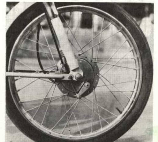
Roue et frein en alliage léger d'un 50 cc sport, l'itom. On remarque le croisement des rayons X4, assez rare sur les machines légères.
