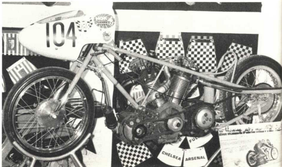
Un vrai monstre : le... 1260 «Jap» bicylindre en V, à compresseur, réalisé par le fameux Alf Hagon. Cette moto est la plus rapide en Europe sur le 1/4 de mile.
