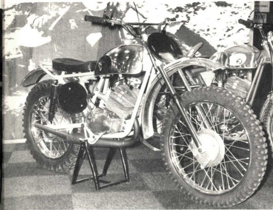
La 125 Dalesman, mini-moto de cross qui fait déjà fureur outre-Manche. Joël Robert, le Champion du Monde, a conçu cette machine dont la partie cycle est réalisée en Angleterre et qui est propulsée par le moteur autrichien Puch. En Belgique, ce modèle court déjà et ses 16,5 ch à 7.500 tr/mn pour 77 kg de poids lui ont valu de brillants succès dès ses débuts.
