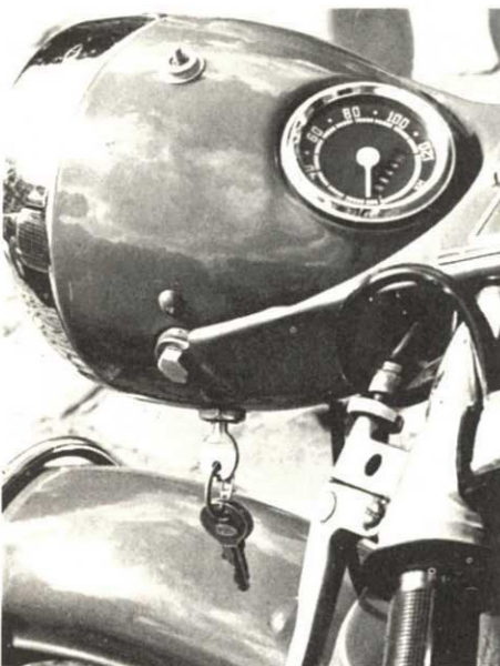
Le possesseur de ce Kreidler l'a équipé d'une clef de contact qui complète efficacement l'antivol de direction.
