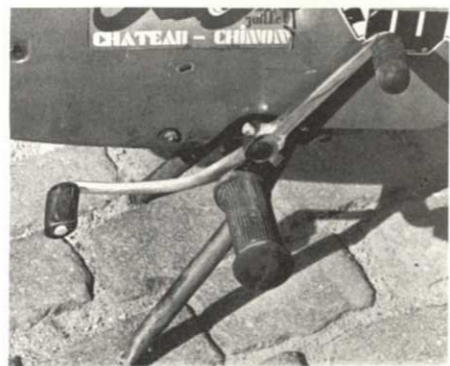
Kick et sélecteur du Kreidler. Le maniement du premier est d'une facilité dérisoire (mise en marche facile à la main !)
