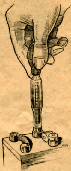
La première des choses à vérifier sur une batterie d'accumulateurs est sa densité; il existe dans le commerce des pese-acide qui mettent ce petit travail à la portée de tous. Certains accumulateurs comportent un système de pese-acide qui permet de voir d'un coup d'œil l'état du liquide; l'accumulateur ci-dessus est un Peto et Radford.
