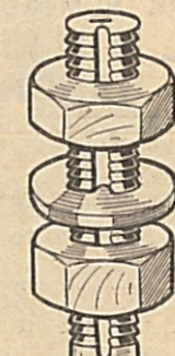
Le frein d'écrou Chéneau constitué par un fil d'acier enroulé dans les spires. — Un des meilleurs freins d'écrou : le contre-écrou, sa rondelle-ergot et la vis avec le logement de l'ergot. — Système peu recommandable en moto : entre cuir et chair.
