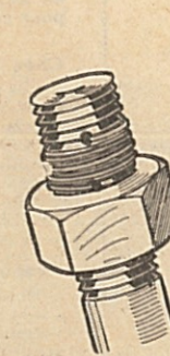
Le frein d'écrou Chéneau constitué par un fil d'acier enroulé dans les spires. — Un des meilleurs freins d'écrou : le contre-écrou, sa rondelle-ergot et la vis avec le logement de l'ergot. — Système peu recommandable en moto : entre cuir et chair.
