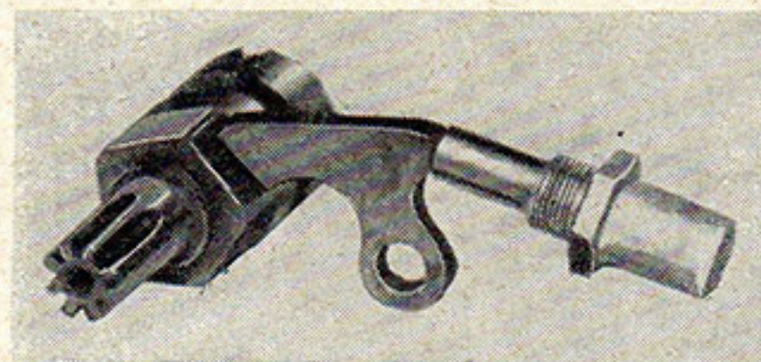
VERROUILLAGE DES VITESSES. LE POUSSOIR APPLIQUE ÉNERGIQUEMENT LA CAME SUR LE PENTAGONE DU BARILLET.
