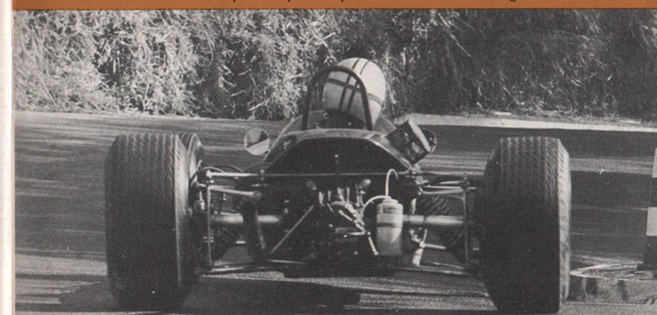
Cette Brabham est ici en plein appui. Le réglage du carrossage est bon, mais la roue arrière gauche sollicitée semble manquer un peu de pincement : elle ouvre légèrement.
