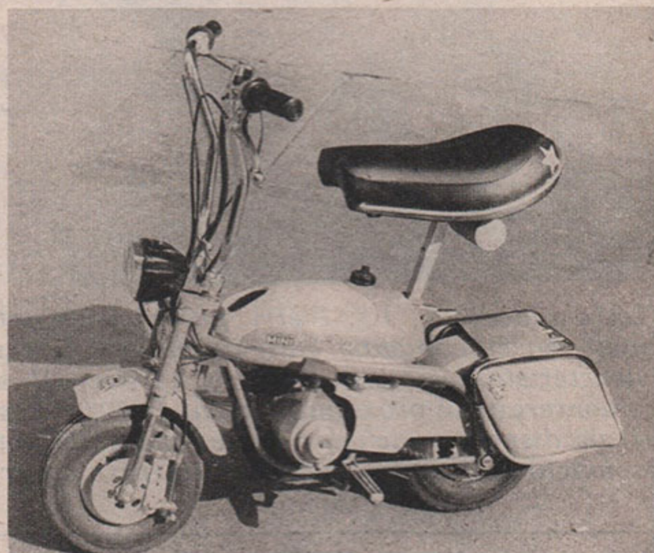
La gamme des cyclomoteurs Moto Guzzi s'est enrichie d'un modèle plus adapté aux exigences de la circulation urbaine: le Dingo monovitesse. Naturellement il est doté un embrayage centrifuge, mise en route à pédale, d'une selle commode et suspendue. Les grandes roues lui confèrent une bonne stabilité et une bonne maniabilité.
