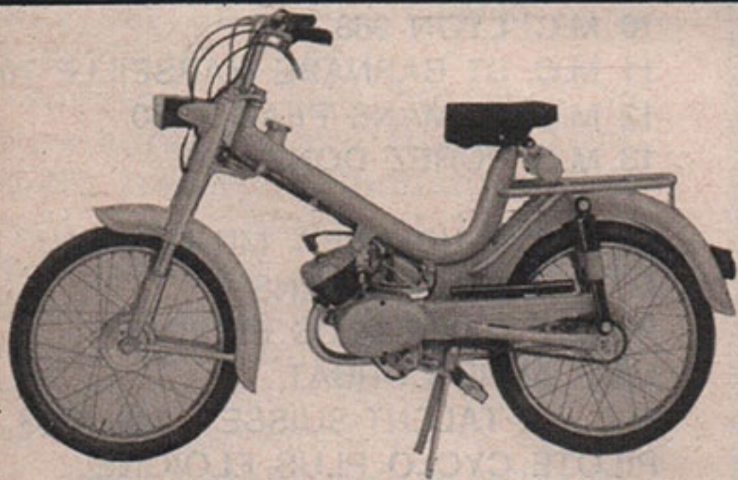
Modèle EZ M 16 - Monovitesse à embrayage automatique. Suspensions avant et arrière Ø Roues 2 - 16
