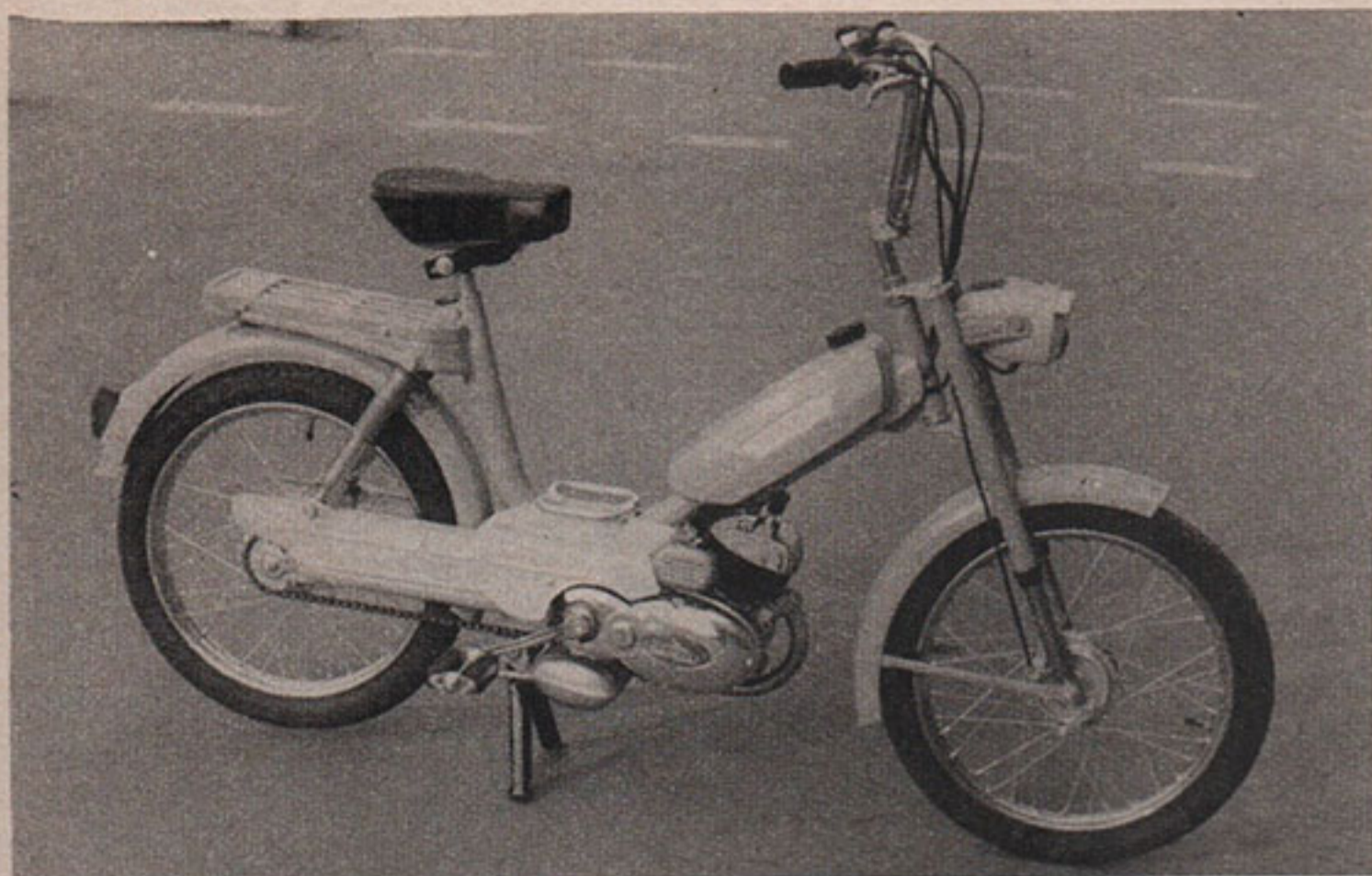
Voici le nouveau Garelli « Gulp Flex » 50 mono vitesse à pédales, avec suspension avant et arrière. Remarquez que le moteur est caréné avec la même tôle qui recouvre la chaîne arrière. Les roues sont de 16" pour améliorer la stabilité et les pneus de large section pour améliorer le confort.
