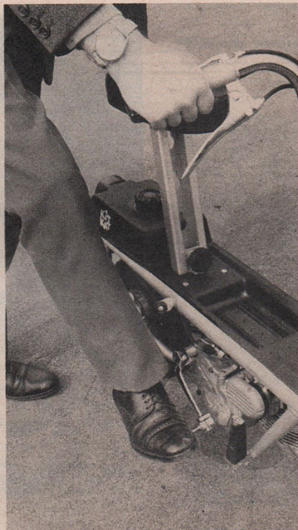
Le robinet d'essence, à trois positions, se trouve trop exposé aux projections de la roue. Notez la grosse section du pneu arrière qui contribue au confort.
