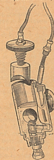
Le carburateur Amac du type T. T. : le croquis de gauche montre la coupe des boisseaux d'air et de gaz.
