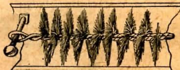
Le Bonza anglais a trouvé une ingénieuse solution au moyen d'une brosse spiro-métallique ; si les poils ont, avec le temps, été couchés par la force des gaz, il est facile de doubler l'usage en retournant le balai.
