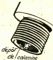
Les ratés d'allumage proviennent souvent d'un grain minuscule de suie qui vient se déposer entre la pointe d'électrode et le corps de la bougie, détruisant l'étincelle en provoquant un courant sans solution.
