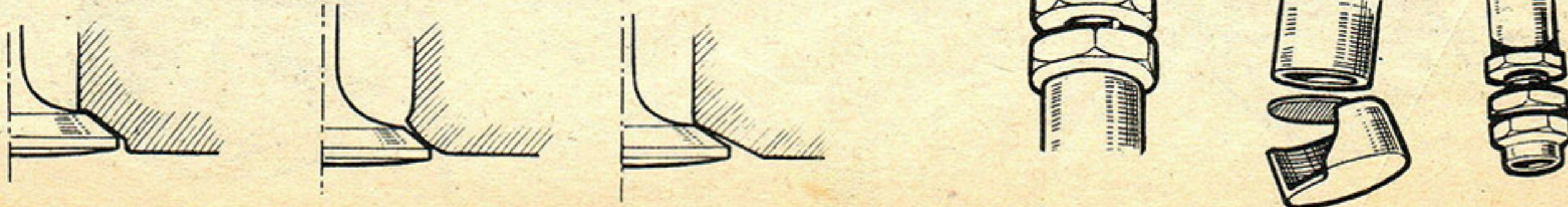
Avant le remontage, une soupape doit être parfaitement polie. Sur celle de droite les points noirs sur la portée, sont de petits creux. En bas, à gauche : 3 mauvaises portées. A droite : 3 systèmes de réglage du jeu.
