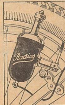
Ce croquis montre l'entraînement de la dynamo par le pneu arrière à une manette à manœuvrer et c'est tout.
