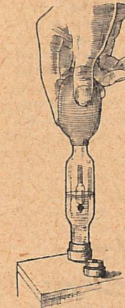
Employer un densimètre est certainement le meilleur procédé de vérification des accus.
