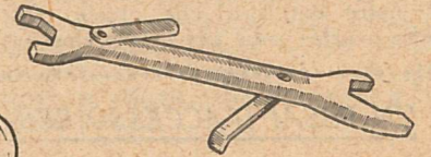
Une clef servant à régler les culbuteurs comporte deux lames pour l'écartement des tiges et le jeu à laisser.
