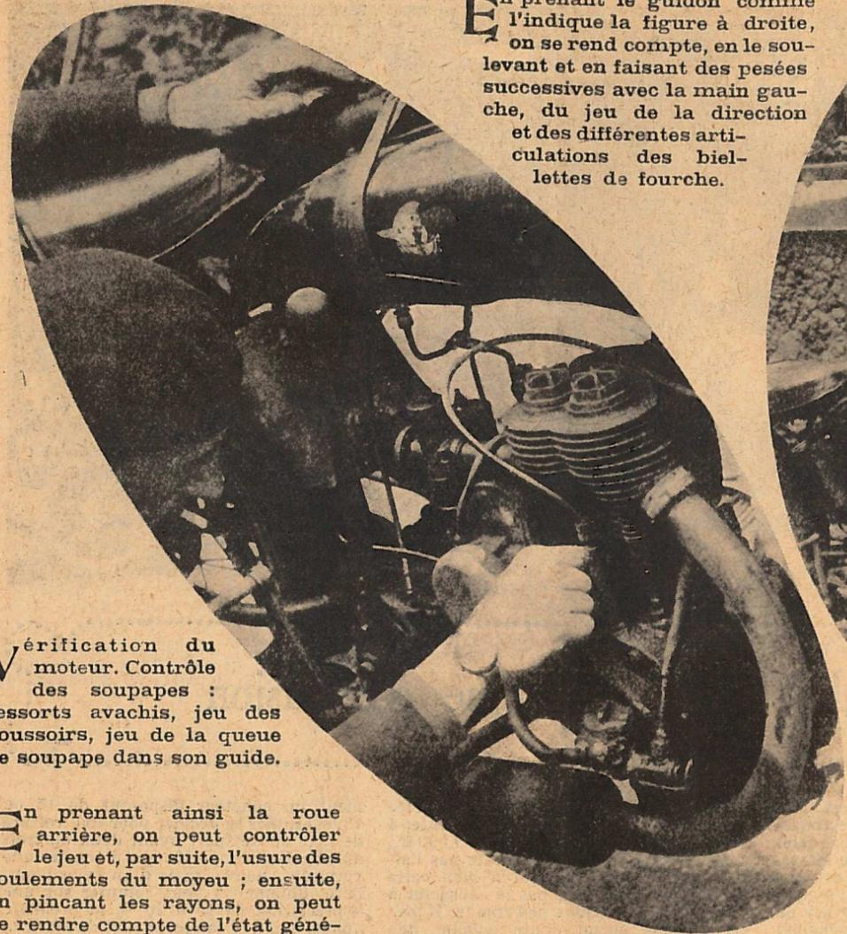
**V**érification du moteur. Contrôle des soupapes : ressorts avachis, jeu des poussoirs, jeu de la queue de soupape dans son guide.
