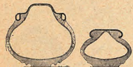
Le pneu ordinaire se casse en s'écrasant ; le ballon est plus souple.
