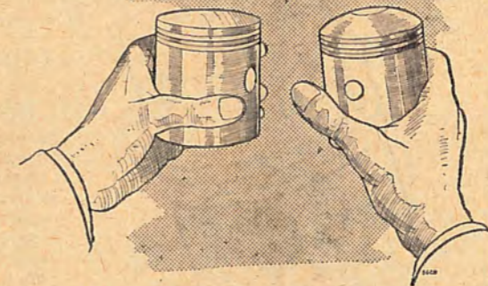
Changer le piston plat pour le piston bombé pour la marche à l'alcool
