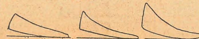
L'emploi de l'alcool augmente la violence de l'explosion et le taux de compression ; le diagramme est pointu.
