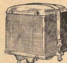
Du sulfatage sur les attaches de la boîte d'accus vous indique un bouchon mal vissé ou une fuite plus grave du liquide.
