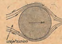
Si l'on a une sphère comme obstacle, la marche des filets d'air est beaucoup plus progressive et, de ce fait, la pression et la dépression sont très atténuées.
