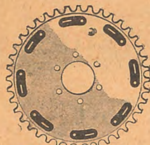
Le pignon de chaîne est entraîné au moyen d'une couronne rentrée sur le moyeu : 8 caoutchoucs accouplent le pignon en formant amortisseurs.
