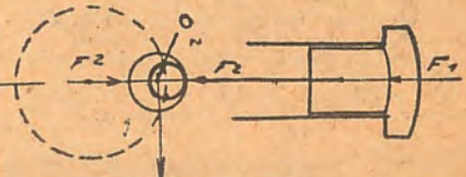
Fig. 4. — Si le moteur est horizontal, le poids de la tête de bielle et d'une partie de la bielle P provoque un décalage dans la production du cognement, qui peut ainsi se produire quelques degrés avant le point mort haut ; en outre, le phénomène se produit progressivement avant de passer par un maximum.
