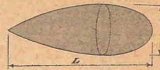
On a comparé le corps fuselé à la goutte d'eau qui, automatiquement, prend, quand elle tombe dans l'air, la forme offrant la moindre résistance de pénétration : L=3 à 5 fois le diamètre.
