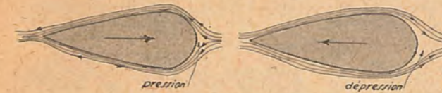
Contre un corps sphéro-conique, les filets se reformant beaucoup plus aisément : de plus il règne, dans ce cas, une zone très marquée de dépression : à droite, la résistance est deux fois plus grande qu'à gauche.
