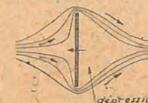
Autre schéma montrant clairement la marche des filets d'air.
