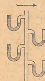
Voici le tube de Pitot enregistrant, à droite, une dépression, à gauche, une pression.
