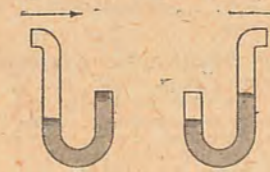
Voici le tube de Pitot enregistrant, à droite, une dépression, à gauche, une pression.
