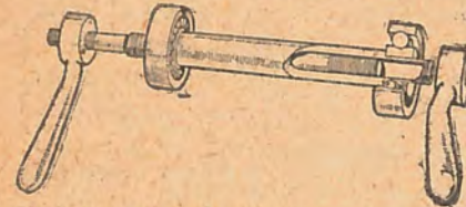
L'axe creux où on le voit, supportant les roulements des moyeux ; en bout, les écrous-papillons.
