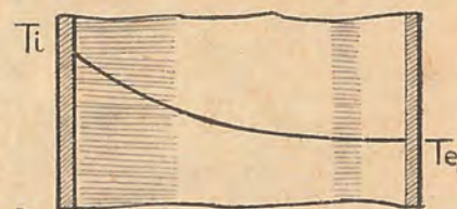
La transmission de la chaleur dans la paroi d'un cylindre : T_i = température intérieure de la paroi ; T_e = température extérieure de la paroi ; au temps de détente, la paroi absorbe la chaleur.
