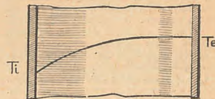
Au temps d'admission, la paroi restitue de la chaleur aux gaz frais.
