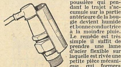
poussière qui pendant le trajet s'accumule sur la partie antérieure de la bougie devient humide et bonne conductrice à la moindre pluie. Le remède est très simple il suffit de prendre une lame d'acier flexible sur laquelle est rivée une petite pièce mécanique qui formera écran : la lamelle d'acier sera recourbée en forme de pince pour entourer le corps de la bougie. — M. BURTIN, Pagny-sur-Moselle n° G. 11 (A gagné une bougie Unus).
