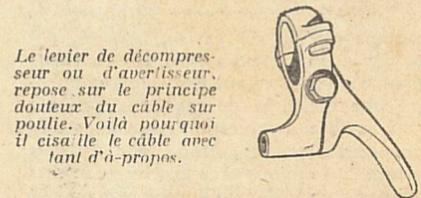
Le levier de décompresseur ou d'avertisseur, repose sur le principe douteux du câble sur poulie. Voilà pourquoi il cisaille le câble avec tant d'à-propos.
