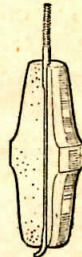
Une bougie chaude, doit posséder un gros isolant et une électrode mince, qui empêchent une répartition rapide de la chaleur.
