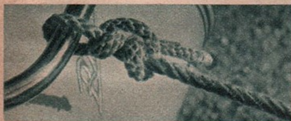
Das sind „zwei halbe Schläge“ — zieht sich unter Last sehr fest zusammen und ist nur schwer wieder zu öffnen.
