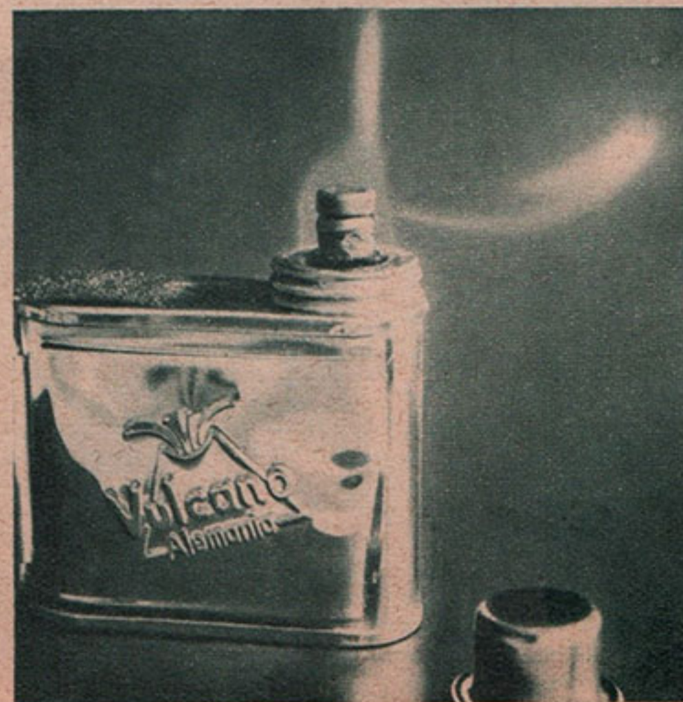
Das ist die richtige Spirituslötlampe zum Nippellöten, mit der Spitze des waagerechten Stichflämmchens wird gearbeitet. (Lötapparatefabrik Ernst Hähnel GmbH., Lüdenscheid.)
