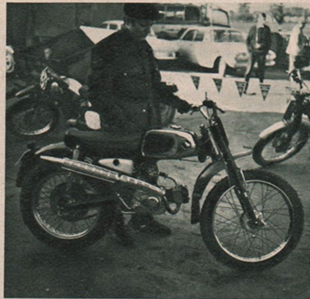
Die 50er Honda von Lienert. Vorne sitzt die bei Trialbastlern wegen ihres geringen Gewichtes beliebte Dürkopp-Gabel drin. Der Apparat müßte nur mehr Hubraum haben.
