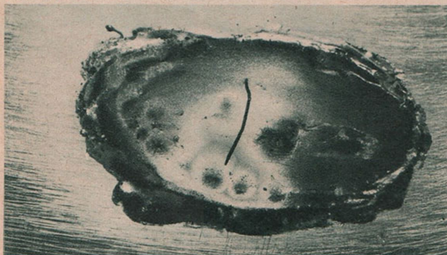
Der Tank wurde saubergefeilt und dann verzinkt. In der Mitte ist das Lot recht gut geflossen, doch der Kolben war nicht hei genug, um das gut khlende Tankblech weit genug anzuheizen. Am Rande rechts unten sind noch kleine Wlle aus Zinn. Der Riverlauf wurde nachtrglich ins Foto gezeichnet. Man beachte die Form des Flickens quer zum Ri!
