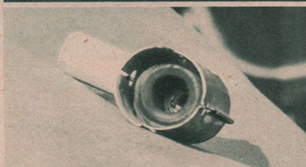
Der Bosch-Silicon-Stecker für gerade Zündkabelzuführung. Für ihn gilt das gleiche wie für den abgewinkelten Stecker. Unverwundlich. ▲
