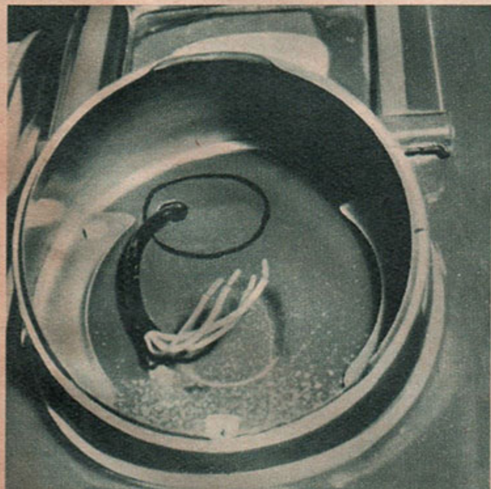
Der Blick in das Scheinwerfergehäuse mit der eingezeichneten wünschenswerten Öffnung, die das Abklemmen der Kabel ersparen kann, wenn die Haube abgenommen werden soll.
